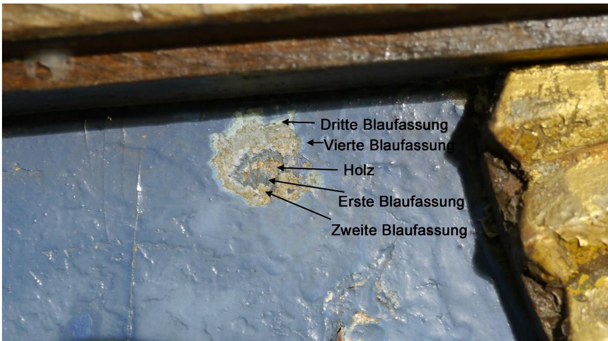
Abb. 4: Blauer Hintergrund: Es lassen sich vier Blaufassungen nachweisen. Die originale Fassung ist etwas dunkler als die heutige.
